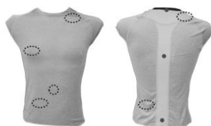
Abb. 2: Lokalisation der Sensoren (links: ventrale-, rechts: dorsale Ansicht), die 3 erforderlichen Sensoren (Punkte) und Bereiche, in denen 1 Sensor platziert werden sollte (Ellipsen).
